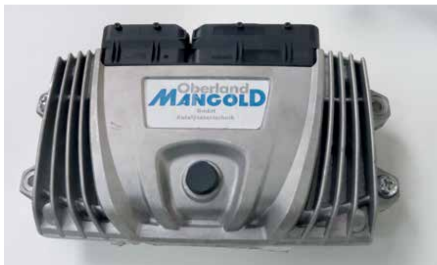
Das Steuergerät des SCR-Systems arbeitet autark vom Motormanagement des Fahrzeugherstellers. Die Einbauorte werden vom Nachrüster nach den Gesichtspunkten Platzangebot, Zugänglichkeit und Beschädigungssicherheit ausgewählt.
